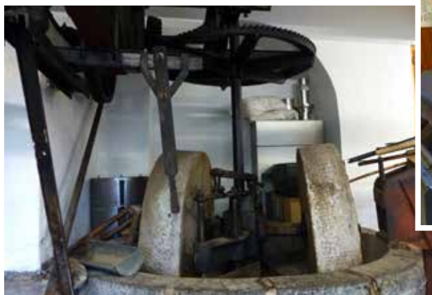
Ci-dessus, l'ancienne presse en fonte et acier « Giordan Père et Fils » et la machine moderne, en bas à droite. En haut à droite, le moulinier Jean-Claude Pellegrino devant le cylindre de la séparation de la pâte et de l'huile. (Photos D.V.)
