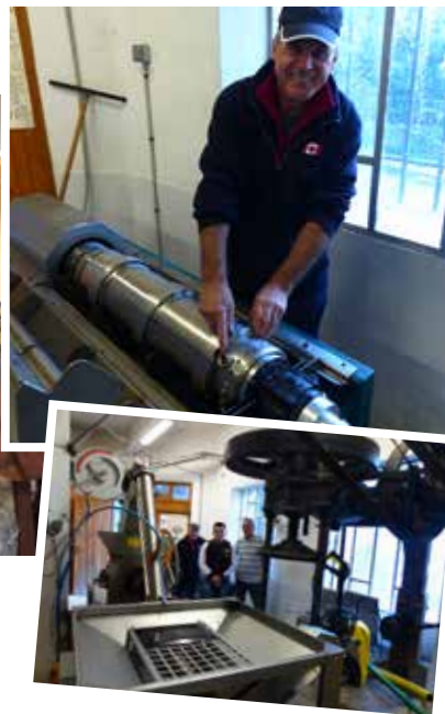
Ci-dessus, l'ancienne presse en fonte et acier « Giordan Père et Fils » et la machine moderne, en bas à droite. En haut à droite, le moulinier Jean-Claude Pellegrino devant le cylindre de la séparation de la pâte et de l'huile. (Photos D.V.)
